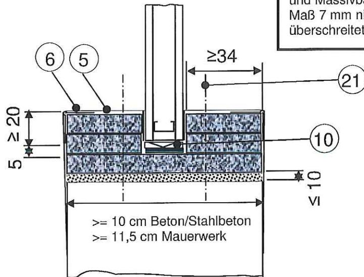
Bauart zum Errichten der Brandschutzverglasung „FIRE-GIP 30“
