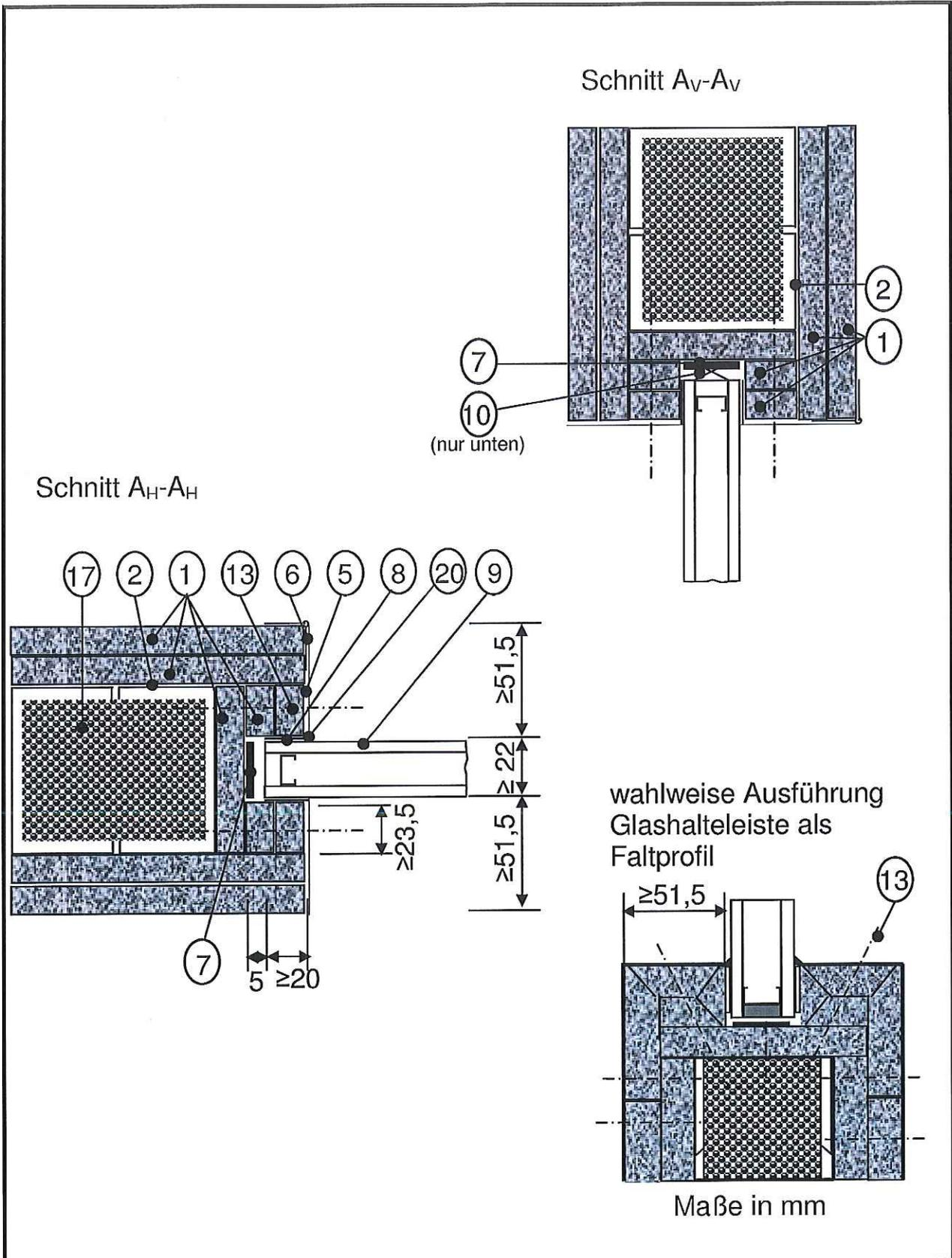
Bauart zum Errichten der Brandschutzverglasung „FIRE-GIP 30“
