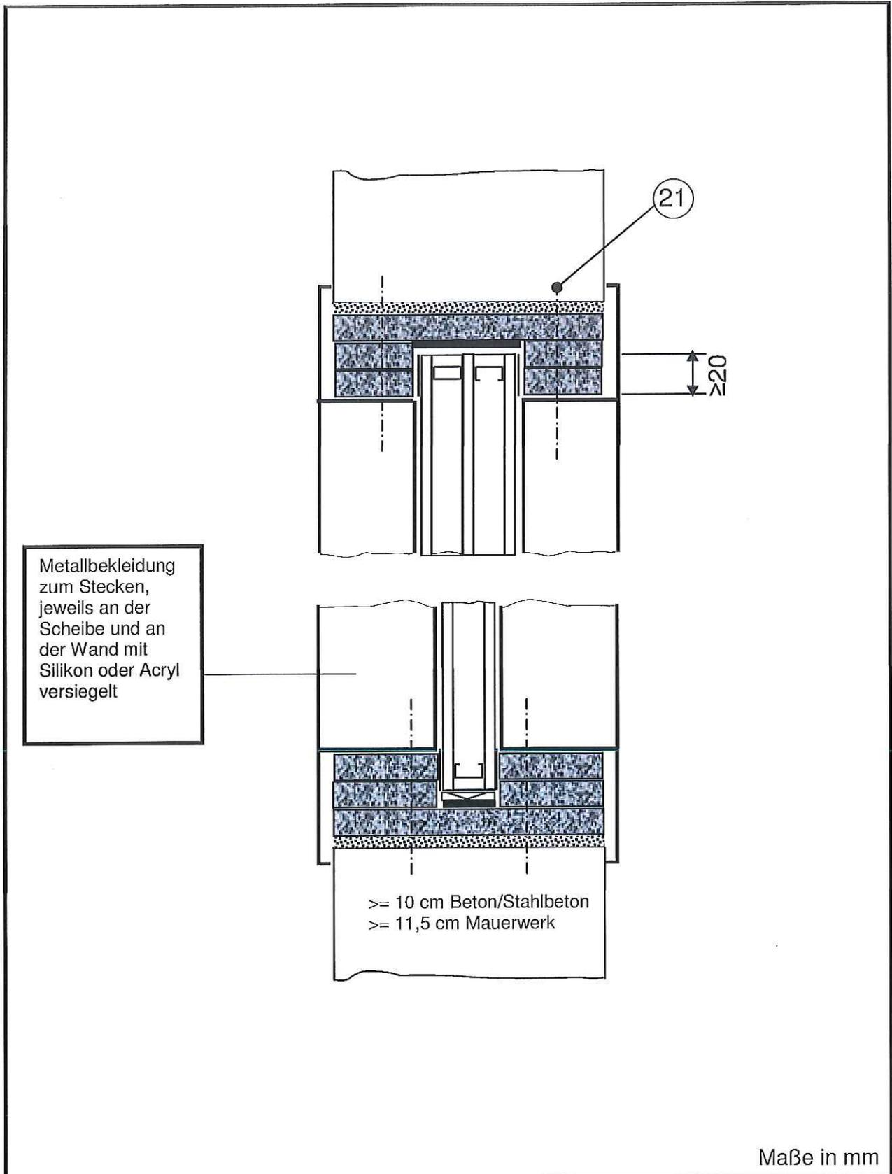
Bauart zum Errichten der Brandschutzverglasung „FIRE-GIP 30“
